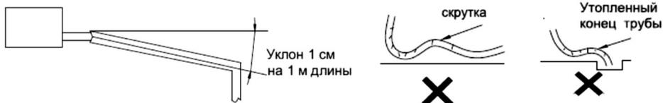
При прокладке дренажной трубы через стену или пол необходима установка стальной закладной втулки. Втулка должна на 20 мм выступать над поверхностью стены и не изменять наклон трубы. Зазор между втулкой и трубой должен быть заделан мягким негорючим материалом. Втулка не должна служить опорой трубы. Соединение отрезков труб должно находиться вне закладной втулки.
